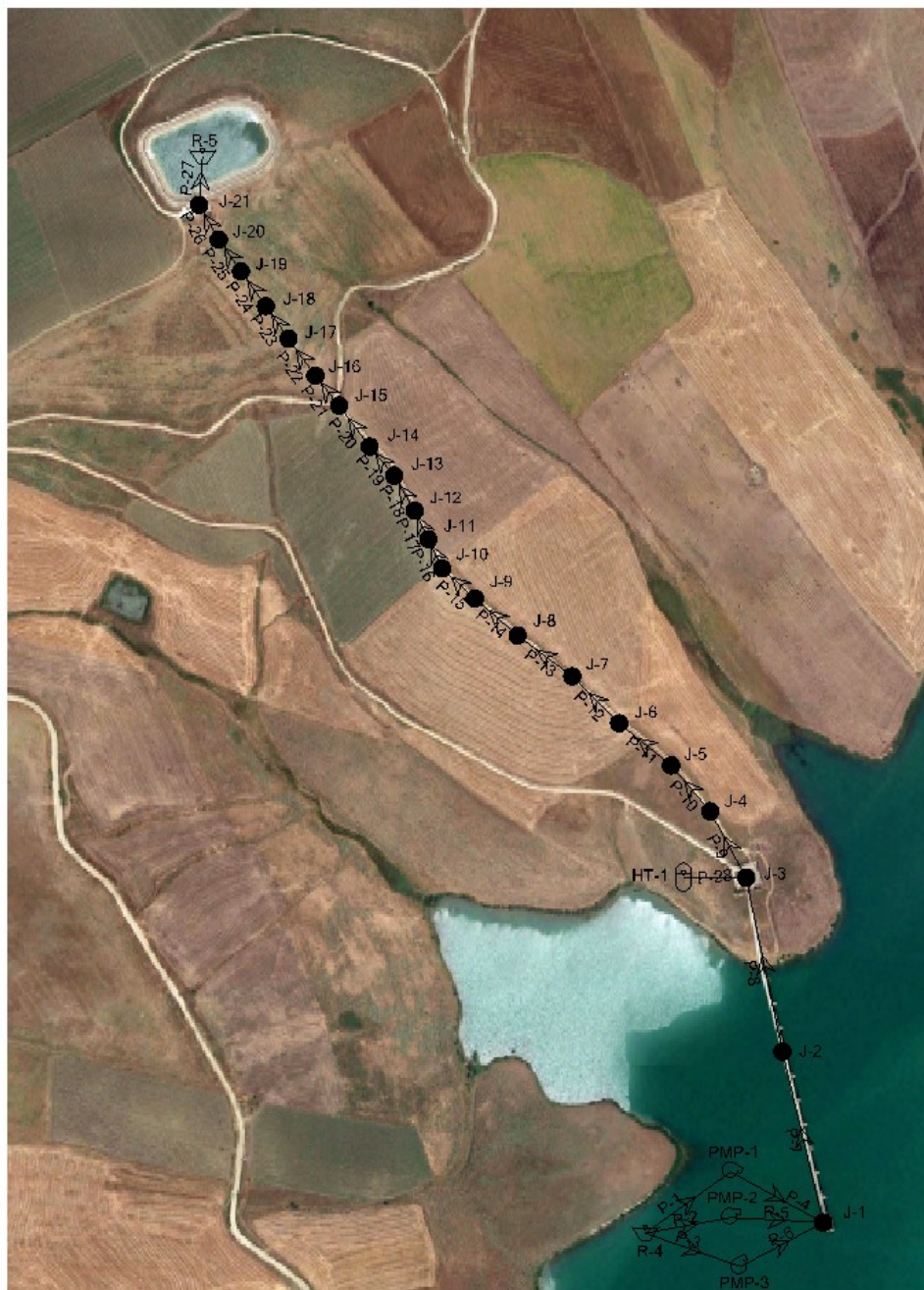
Figura 1- Modello di calcolo condotta premente su orto foto del tracciato
